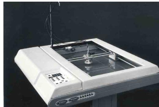
Рис.2. Опытный образец сканирующего устройства со встроенным вычислительным блоком, предназначенный для количественной оценки визуальной массы и её производных
